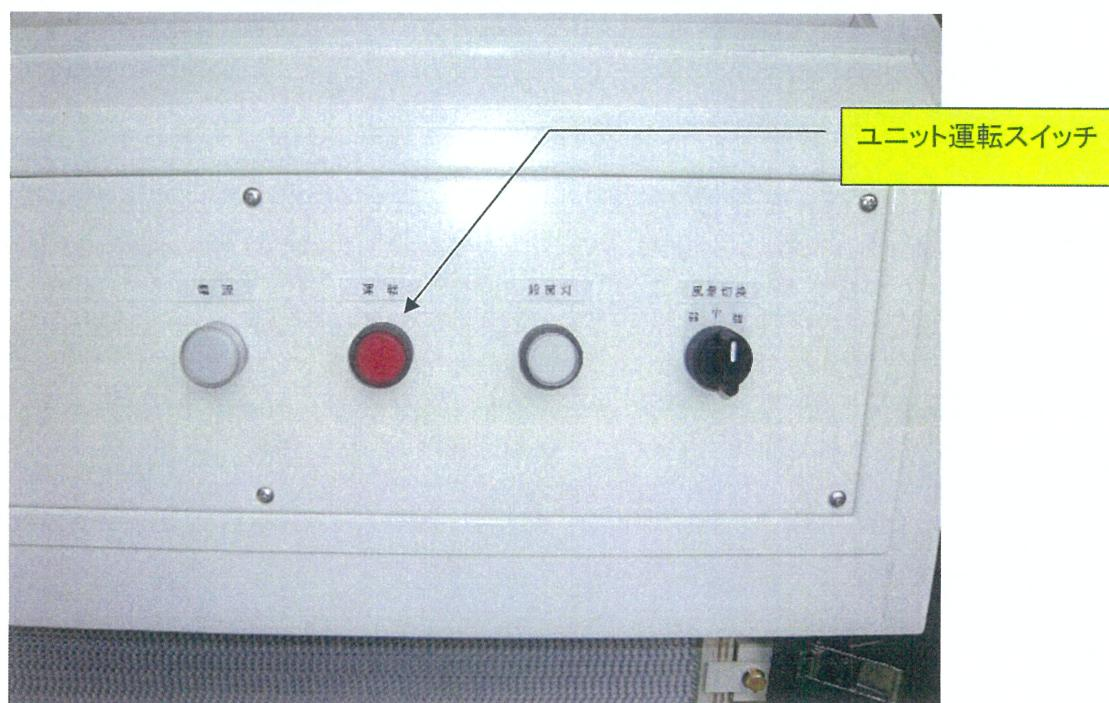
部屋に広さにより風量を切替（強一中一弱）で陰圧度を調整します。
